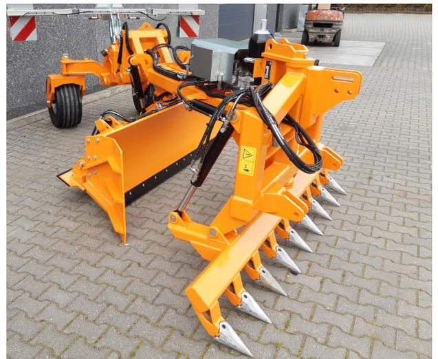
Dieses Gerät bietet die Möglichkeit mit der Kombination Planierschild und Wege / Planierschiene in einem Arbeitsgang einzuebnen und abzuziehen. Die Arbeitstiefe ist stufenlos verstellbar. Das Fahrwerk mit extra breiten Reifen sorgt für einen ruhigen Lauf beim Planieren sowie beim Transport auf der Straße.
